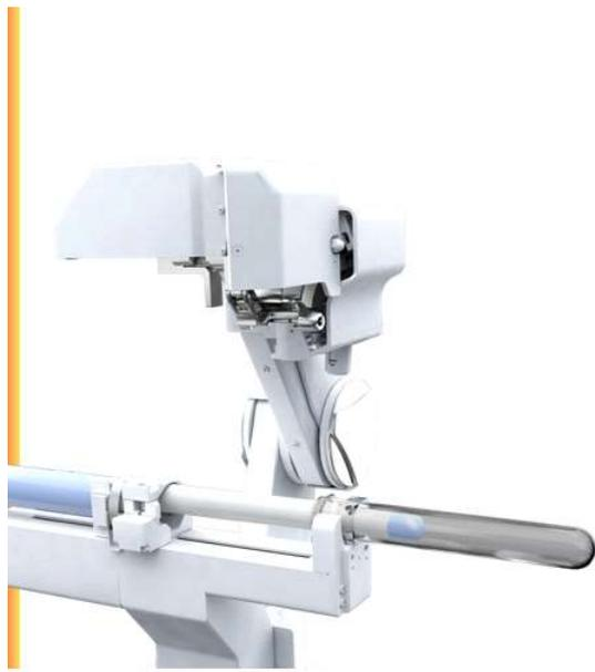
圖 3、藉由機器人手臂可以讓切片過程更穩定
